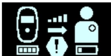
**Figura 40: Schermata di stato dell'IPG di ricarica quando si ricarica l'IPG in modalità di carica speciale**
