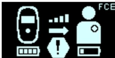
**Figura 49: Schermata di stato dell'IPG di ricarica FCE quando si ricarica l'IPG in modalità sicura**
