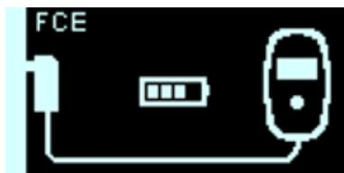
**Figura 43: Schermata di stato dell'autoricarica del caricatore FCE**
