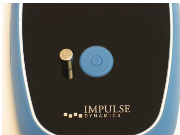
Figure 39 : Aimant d'appariement sur le Vesta Charger
