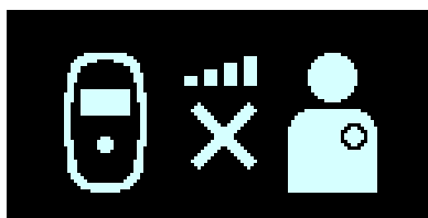
Figure 14 : Écran d'erreur de couplage de l'IPG en charge
