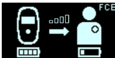
Figure 51 : Écran d'état de la recharge de l'IPG par le FCE en mode de recharge non appariée
