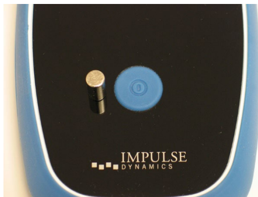
Figure 29 : Aimant d'appariement sur le Vesta Charger
