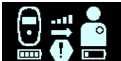
Figure 40 : Écran d'état de la recharge de l'IPG en mode de recharge spécial
