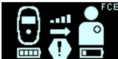
Figure 49 : Écran d'état de la recharge de l'IPG par le FCE en mode sécurisé
