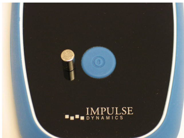
Figure 50 : Aimant d'appariement sur le Vesta Charger
