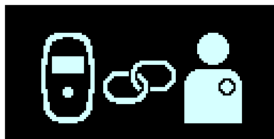
Figura 7: Pantalla de emparejamiento del cargador/IPG
