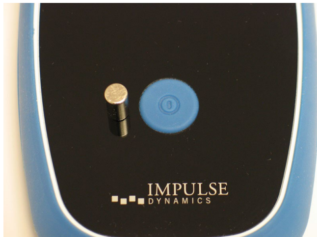
Figura 50: Imán de emparejamiento en el cargador Vesta
