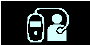
Figura 21: Pantalla de alerta de tiempo prolongado sin cargar el IPG
