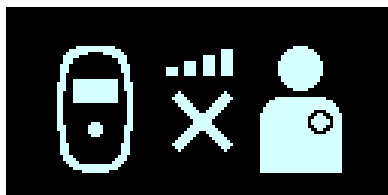
Figura 14: Pantalla de error de carga por emparejamiento del IPG
