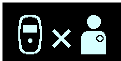
Figura 9: Pantalla de error de emparejamiento del cargador/IPG
