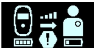
Figura 40: Pantalla de estado de carga del IPG cuando se carga el IPG en el modo de carga especial
