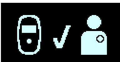
Figura 46: Pantalla de emparejamiento exitoso del cargador/IPG
