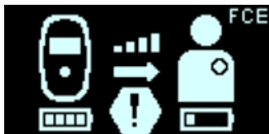
Figura 49: Pantalla de estado de carga del IPG del FCE cuando se carga el IPG en modo seguro Cómo cargar el IPG OPTIMIZER Smart Mini en el modo de carga sin emparejamiento
