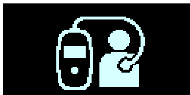
Figura 41: Pantalla de alerta de tiempo prolongado sin cargar el IPG
