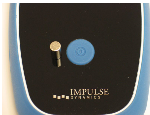
Figura 29: Imán de emparejamiento en el cargador Vesta
