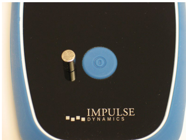
Figura 39: Imán de emparejamiento en el cargador Vesta
