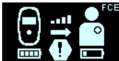
Εικόνα 49: Οθόνη κατάστασης φόρτισης IPG FCE όταν γίνεται φόρτιση της IPG σε ασφαλή τρόπο λειτουργίας
