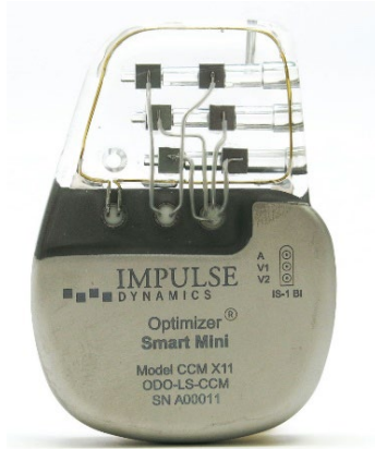
Figure 1: OPTIMIZER Smart Mini IPG
