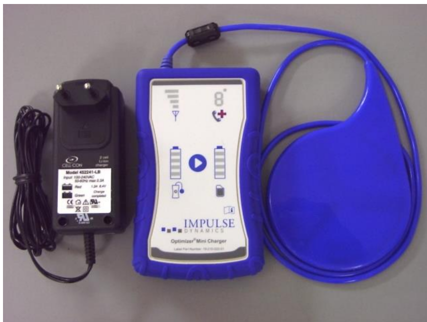
Рисунок 3. OPTIMIZER Mini Charger с переходником для подключения к источнику переменного тока
