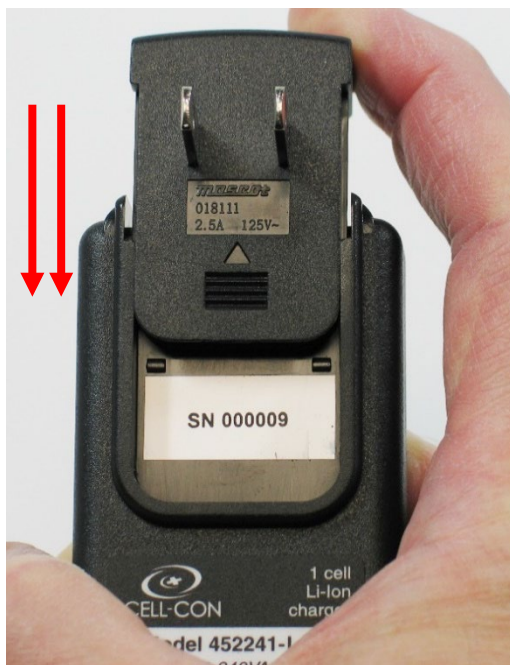
Εικόνα 6: Τοποθέτηση του προσαρμογέα φης
