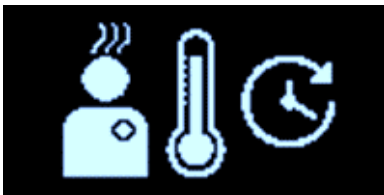
Slika 19: Zaslonski prikaz napake temperature polnjenja vsadnega generatorja impulzov
