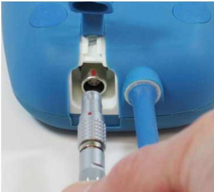
Slika 8: Poravnavanje DC konektora
