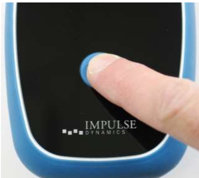
Slika 12: Pritiskanje Gumba za paljenje/gašenje na punjaču
