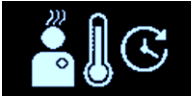
Kuva 19: IPG:n latauslämpötilavirhe -ikkuna
