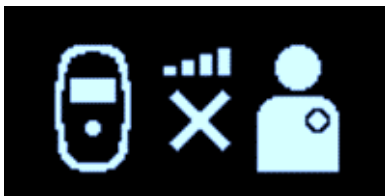
Kuva 16: IPG:n latauksen yhteysvirhe -ikkuna
