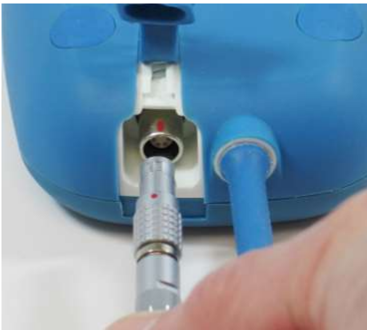
Kuva 8: DC-liittimien asettaminen kohdakkain
