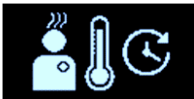
Bild 19: Skärmen temperaturfel vid laddning av IPG
