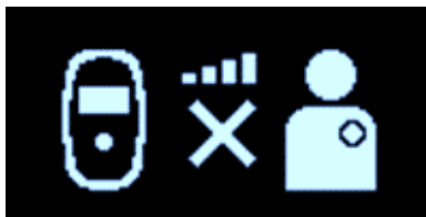
Bild 16: Skärmen kopplingsfel vid laddning av IPG
