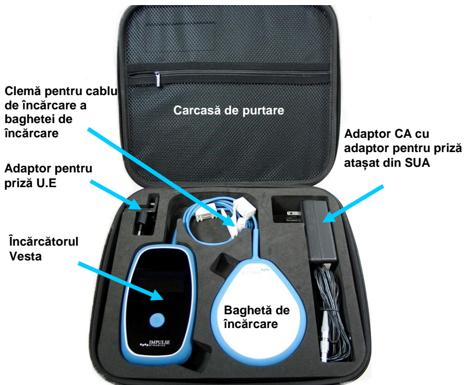
Figura 3: Componente ale sistemului încărcătorului Vesta
