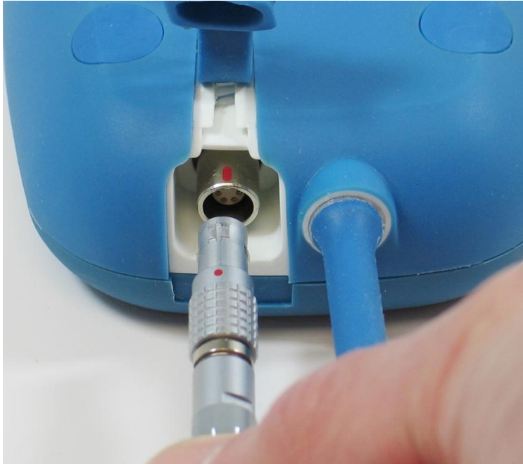
Afbeelding 8: De DC aansluitingen plaatsen
