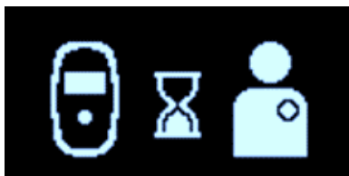
Figure 20 : Écran d'erreur de dépassement de délai de charge du GII
