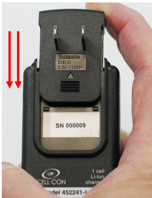
Figure 6 : Installation de l'adaptateur de prise électrique
