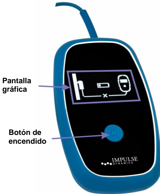
Figura 4: Características del cargador Vesta
