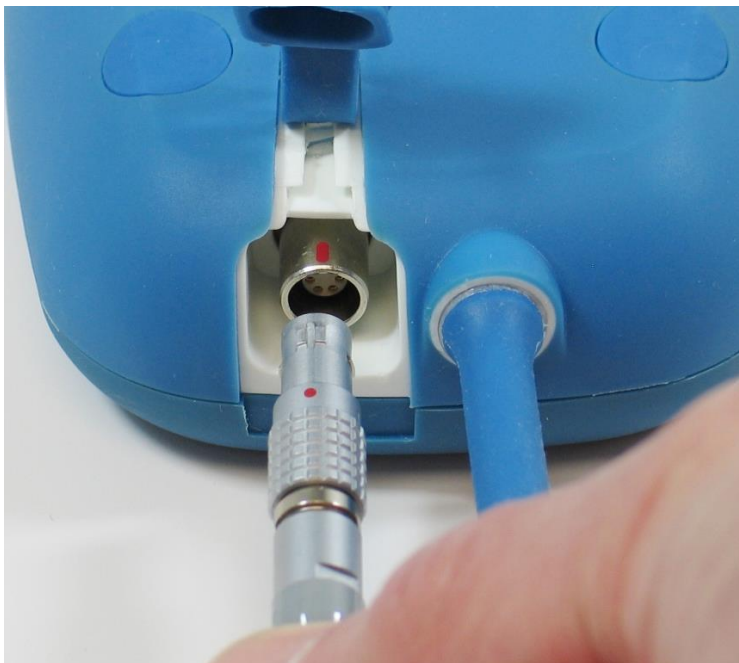
Figura 8: Alineación de los conectores de CD
