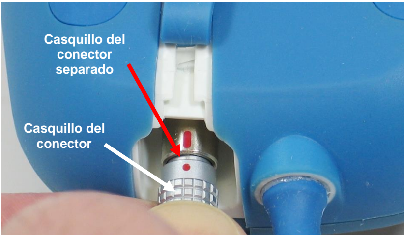
Figura 11: Acercamiento del casquillo del conector
