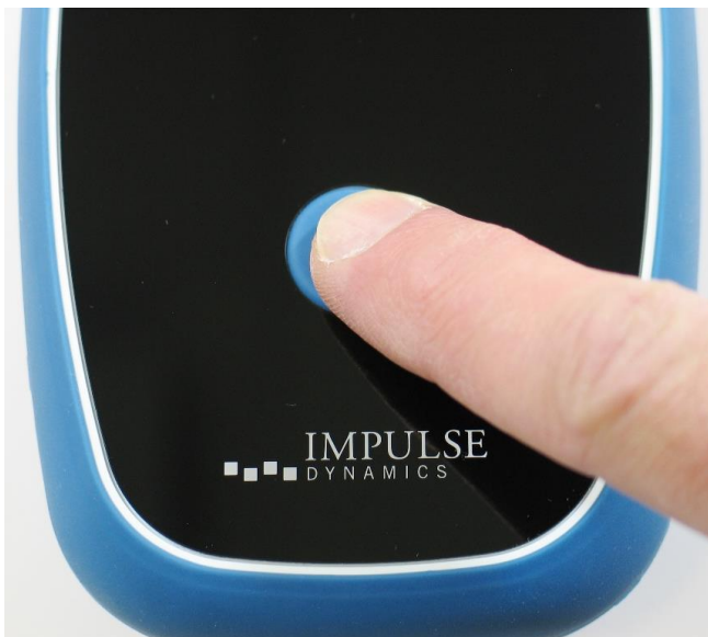
Figura 12: Presión del botón de encendido en el cargador
