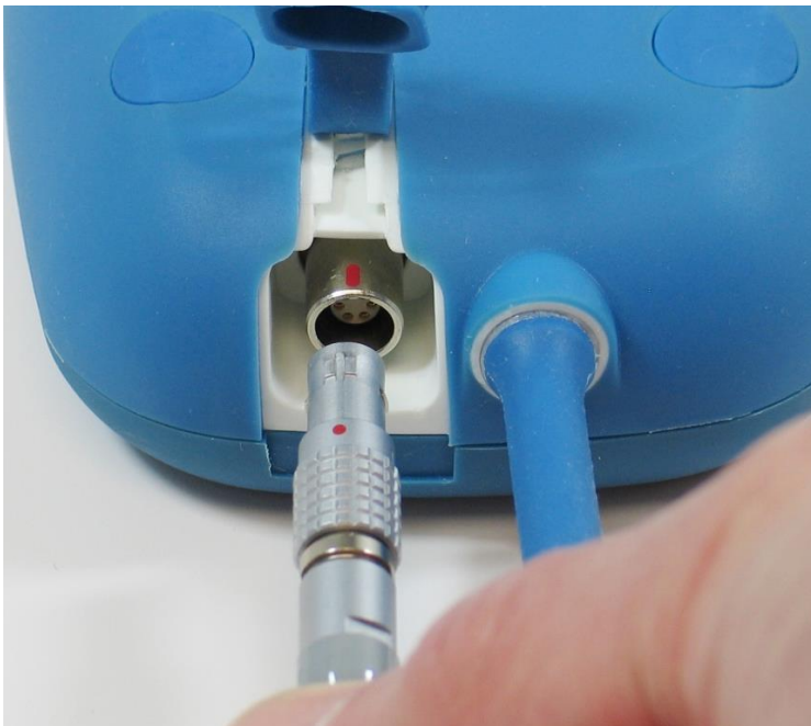
Abbildung 8: Ausrichten der DC-Steckverbinder
