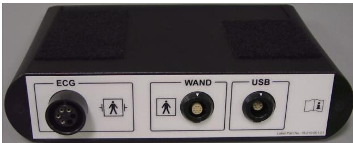
Slika 2: Uređaj *Interface Box* za OMNI II Programmer
