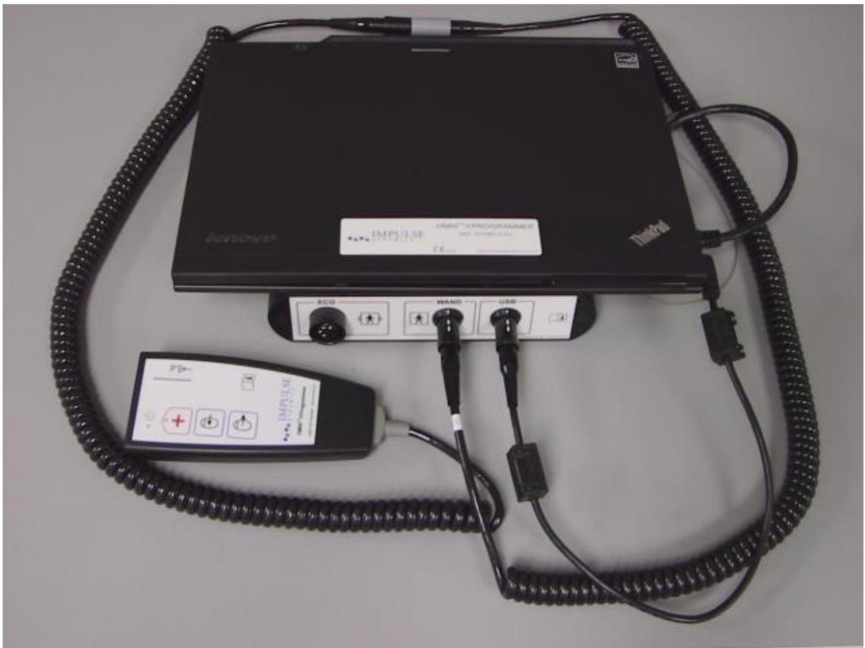
**Slika 1: Sustav OMNI II Programmer (s OMNI Smart Software) i telemetrijska palica sustava Programmer**
