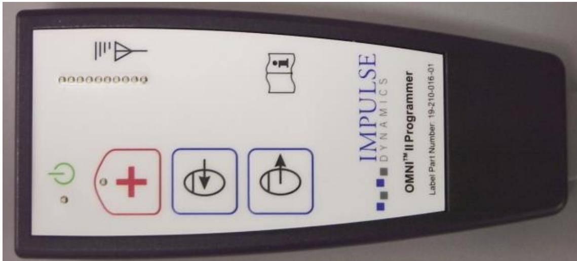
**Slika 3: Telemetrijska palica za OMNI II Programmer**
