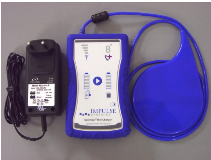
Rysunek 3: Ładowarka OPTIMIZER Mini Charger z zasilaczem na prąd przemienny
