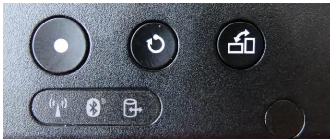
Figura 4: Exemplo de Botões e Símbolos Iluminados no Tablet PC do Programador OMNI II
